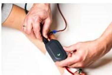
Collegare la batteria al riscaldatore, attendere che l'indicatore luminoso emetta una luce verde fissa.
