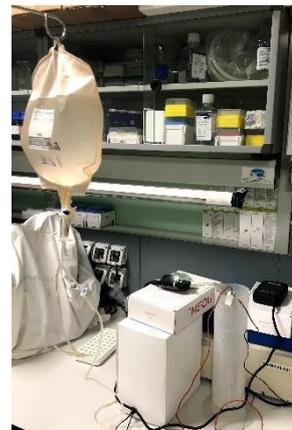
La sonda termica certificata è stata posizionata in modo da rilevare la temperatura del fluido in uscita dal sistema riscaldante; quindi, il deflussore è stato aperto alla massima velocità per simulare condizioni di infusione rapida di EMC.
